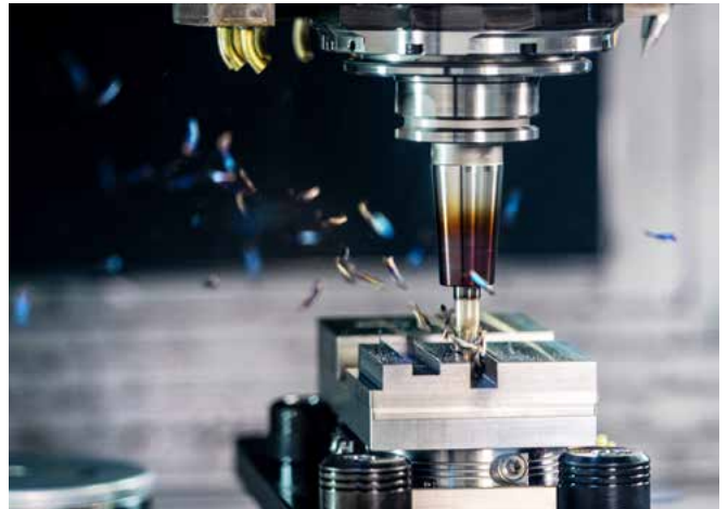
Vollnutfräsen mit Warm Schrumpffutter CELSIO
